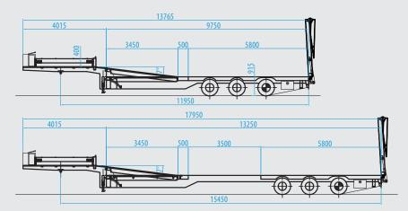
Gesamtgewicht techn.: 48 000 kg Eigengewicht: 13 000 kg Sattellast: 18 000 kg Tiefbettlänge: 9 750 mm Hinterachslast: 30 000 kg Auszug: 3 500 mm
